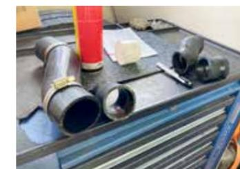
Improvisation für einen geplatzten Kühlwasserschlauch.
